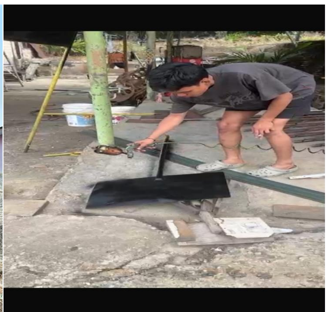
Gambar 4. Proses pengelasan rangka besi dudukan tong sampah oleh mahasiswa KKN
